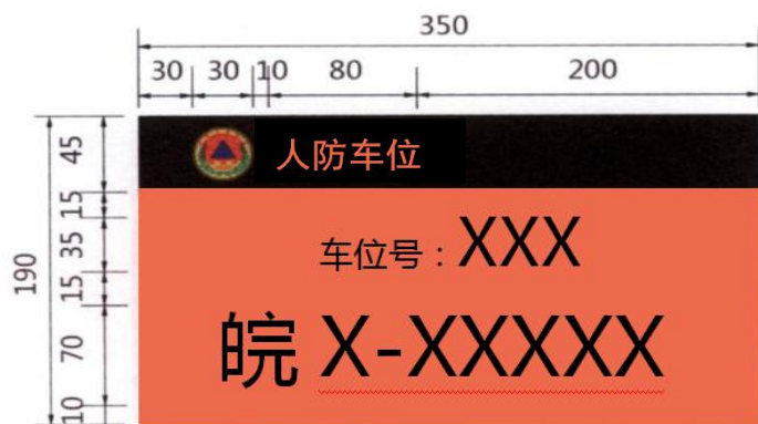
图 18 悬挂式车位标识样式及尺寸示例
