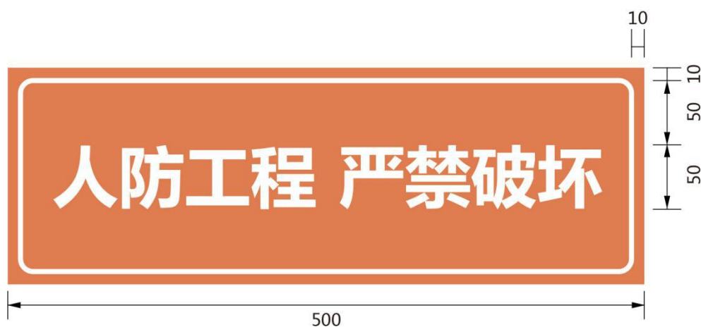
图 36 提示性标识牌样式及尺寸示例
