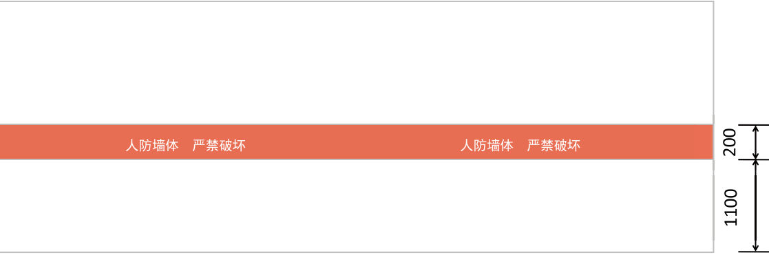
图 16 应配建区墙体标识样式及尺寸示例
