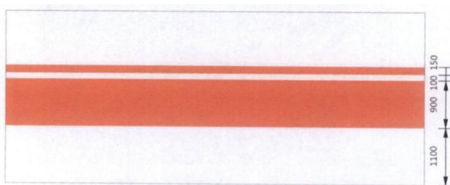
图 20 超配建区墙体标识样式及尺寸示例
