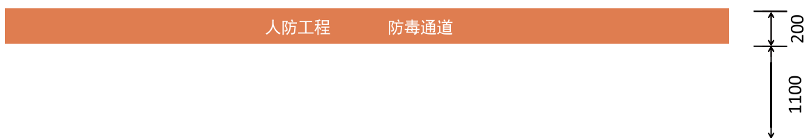
图 24 防毒通道标识样式及尺寸示例
