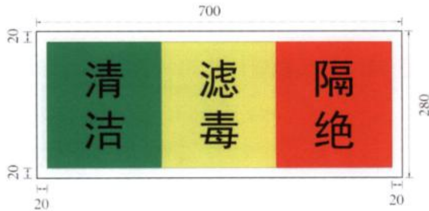
图 31 通风方式显示装置样式及尺寸示例
